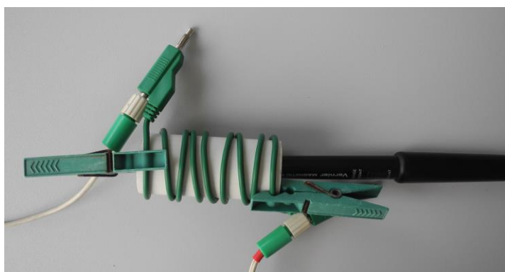
Obr 6 Cívka navinutá na plastové trubce s vloženou sondou magnetického pole. Nahoře hustě vinuté závitů, dole řídko vinuté závitů.
